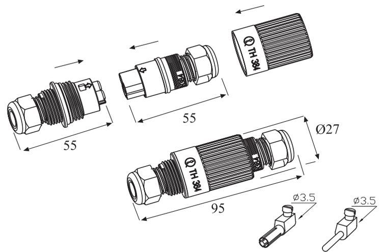
Connessione presa- spina 2-3 poli. Grado di protezione IP54
